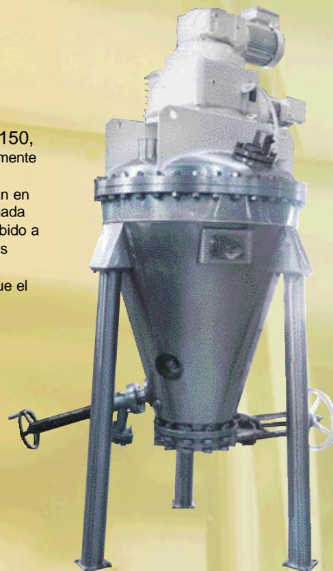
**Licuadora Vertical Modelo V - de 3 - 1 HP.** Esta Licuadora de acero inoxidable está diseñada para operación al vacío/ presión hasta 90 psi. Esta incluye una camisa aislada y enfundada para 125 psi y un puerto de muestreo a través de su pared cónica.
