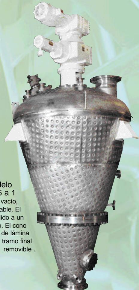
Licuadora Vertical modelo V-64, de 64 cu. ft., 15 a 1 HP. Un modelo al vacío, construido en acero inoxidable. El interior de la unidad está pulido a un grado 140 de acabado. El cono incluye una camisa de lámina repujada seccionada con su tramo final removible.
